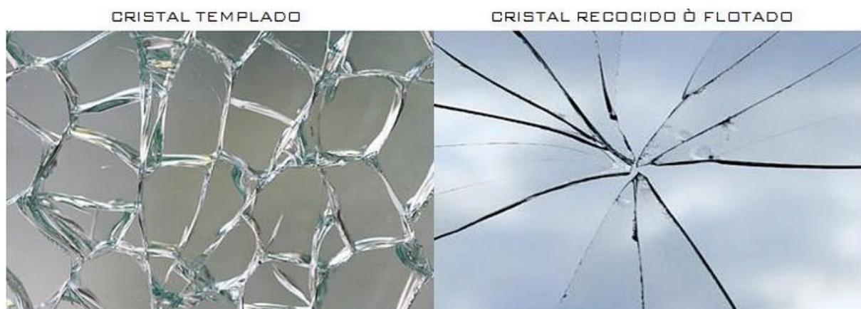
Un cristal templado de 8 mm de espesor resiste el impacto de una bola de acero de 500 gr. de peso, dejada caer de una altura de 2 metros sin velocidad inicial, estando el vidrio templado apoyado en dos listones separados un metro. La misma bola, dejada caer desde 30 cms. de altura, rompe un vidrio pulido del mismo espesor.
